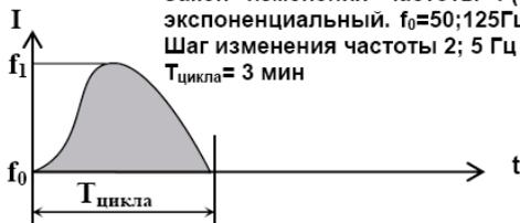
Закон изменения частоты  $F(f_0-f_1-f_0)$  – синусоидальный.  $f_0=50;125$  Гц,  $f_1=1$  Гц
